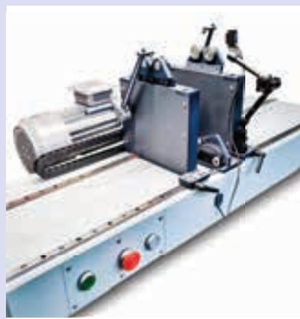
Для балансировки широкого перечня роторов различных масс разработана линейка универсальных балансировочных станков типа xB с горизонтальной осью вращения.
