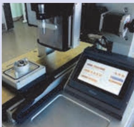
Нашей компанией разработана установка, позволяющая проводить балансировку перспективных металлических твердотельных волновых гироскопов (ТВГ). Балансировка осуществляется локальным удалением массы с торцевой поверхности ТВГ методом сверления.
