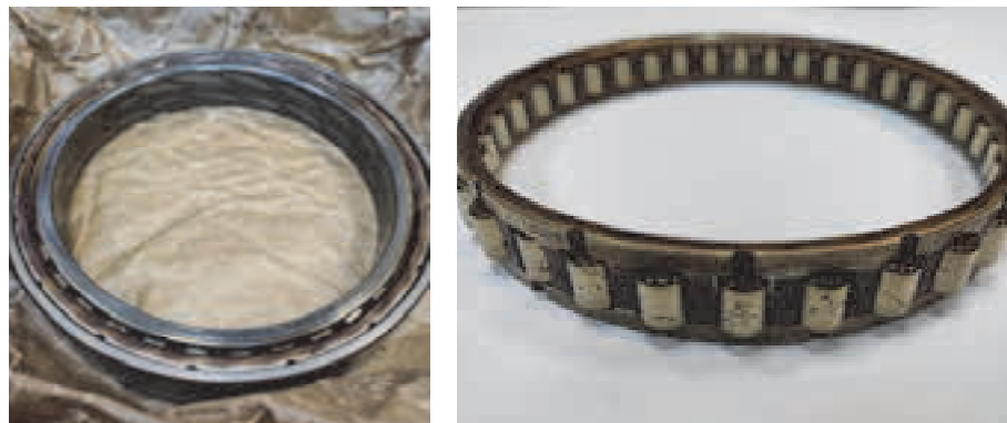
Рисунок 1. Межроторный подшипник ГТД семейства АЛ-31 с эксплуатационными дефектами (наработка 1200 час)
