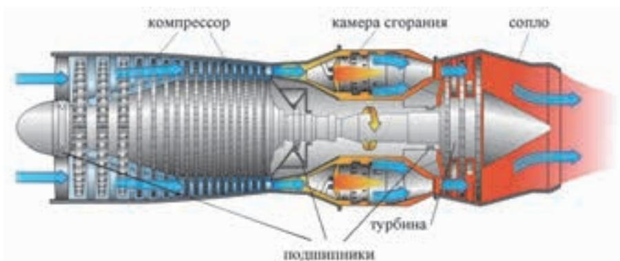
**Рисунок 1. Разрез типового газотурбинного двигателя**
