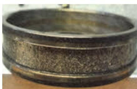
**Рисунок 3. Внутреннее кольцо экспериментального подшипника. На поверхности наблюдаются ярко выраженные раковины**
