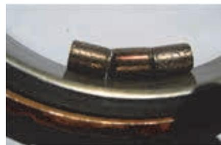
**Рисунок 4. Тела качения экспериментального подшипника. На элементах подшипника обнаружены осповидные раковины**
