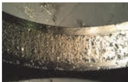
**Рисунок 2. Наружное кольцо экспериментального подшипника. Осповидные дефекты**
