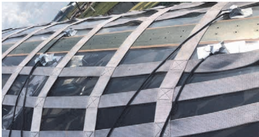
Рис. 3. Размещение датчиков АЭ на фонаре кабины ВС
