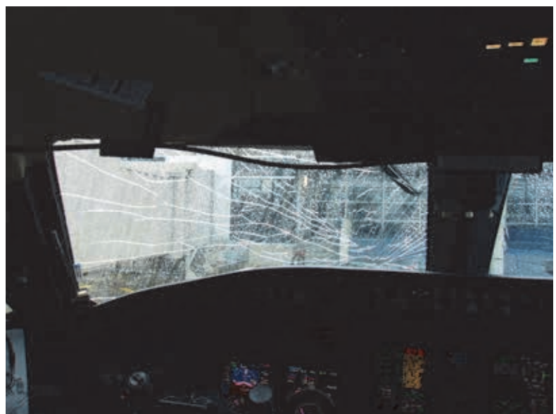
Рис. 2. Разрушение остекления фонаря кабины Airbus A319
