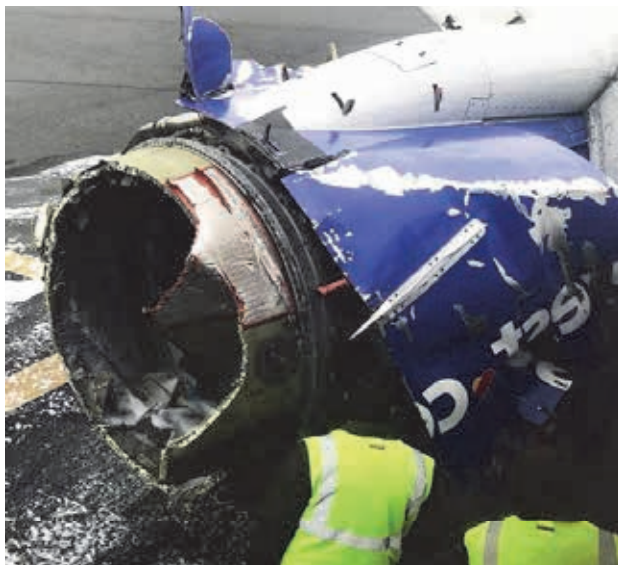
Рис. 7. Последствия возникновения помпажа
