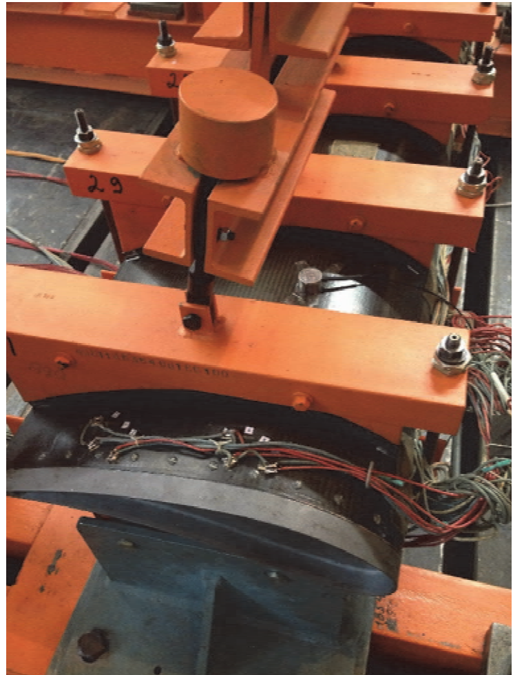
Рис. 5. Прочностные испытания дефлектора закрылка с применением метода АЭ на испытательном стенде
