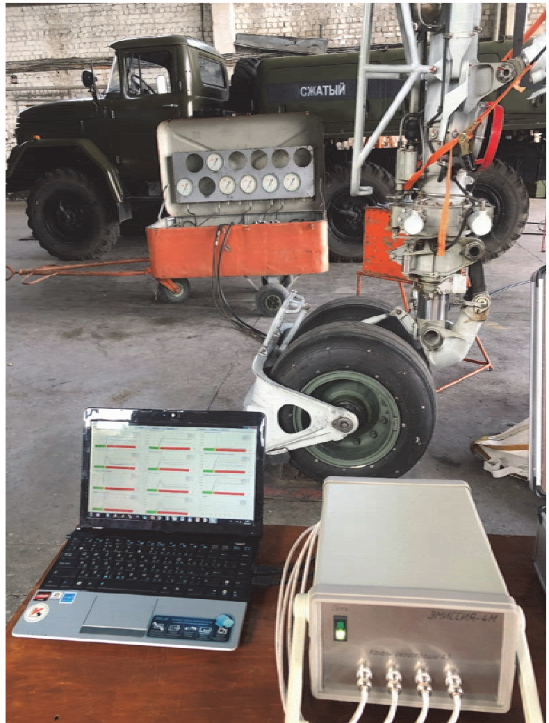
Рис. 1. Диагностирование воздушного судна разработанным АПК
