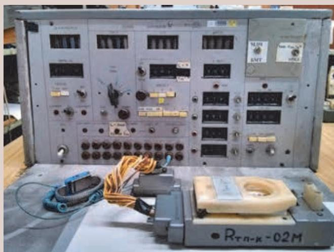
*Измеритель теплового сопротивления РТПК-02*
