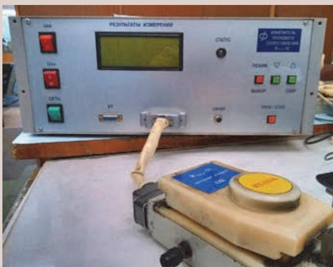
*Измеритель теплового сопротивления РТПК-10*
