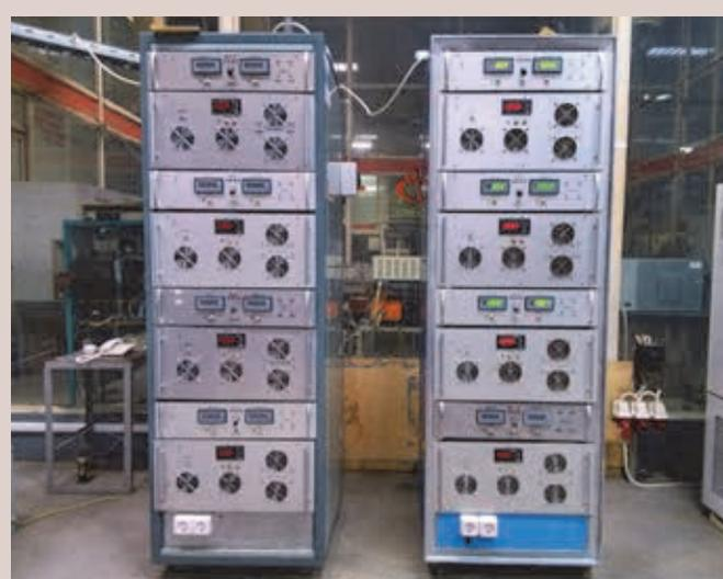
*Комплекс для испытаний на надежность мощных диодов*
