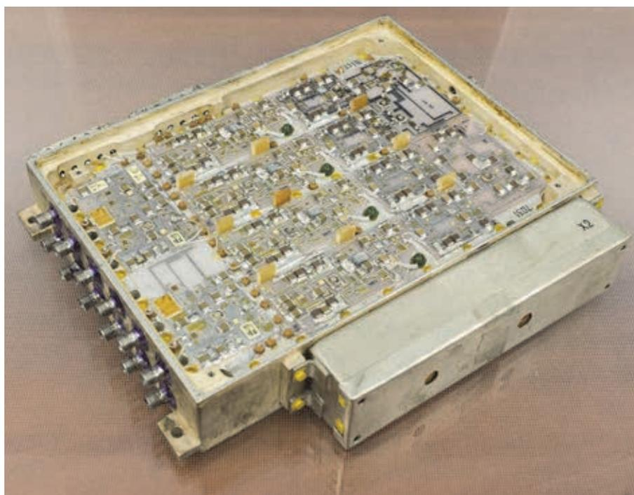
Рис. 1. Пример ГИС с элементами СВЧ диапазона фирмы NEC
