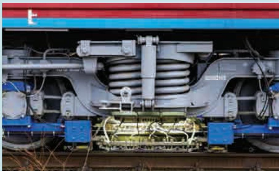
*Обновленная конструкция дефектоскопической лыжи*
