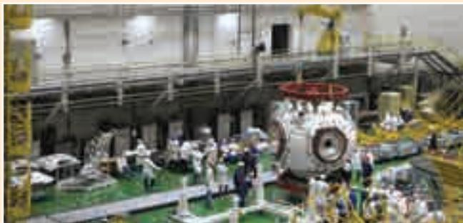
6 октября на техническом комплексе космодрома Байконур начались работы по интеграции узлового модуля «Причал» в состав транспортного грузового корабля-модуля «Прогресс М-УМ», который должен доставить на Международную космическую станцию новый компонент российского сегмента.
