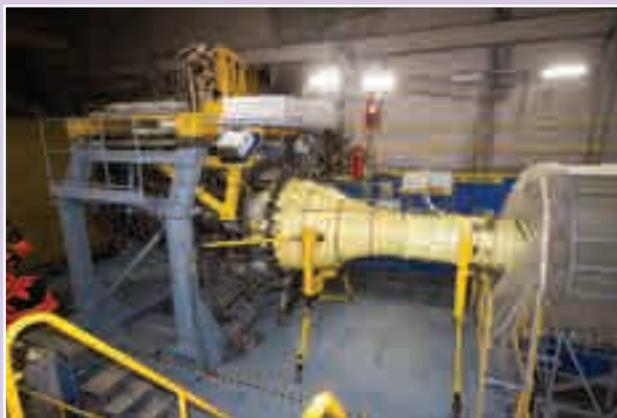
Объединенная двигателестроительная корпорация Ростех завершила сборку газогенератора двигателя сверхбольшой тяги ПД-35 для широкофюзеляжных дальнемагистральных пассажирских лайнеров. Пресс-служба корпорации сообщила, что изготовленный «ОДК-Авиадвигатель» опытный образец уже установлен на испытательном стенде. Первые результаты показывают стабильную работу узлов и систем изделия.
