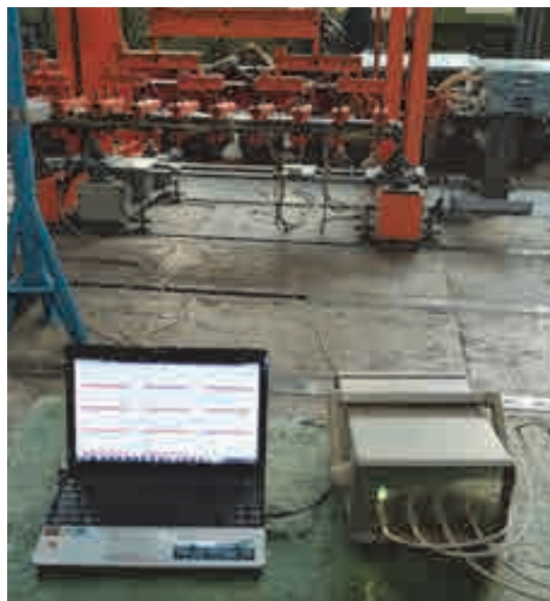
Рис. 1. Разработанный аппаратно-программный комплекс на основе метода АЭ «Эмиссия-4» у испытательного стенда
