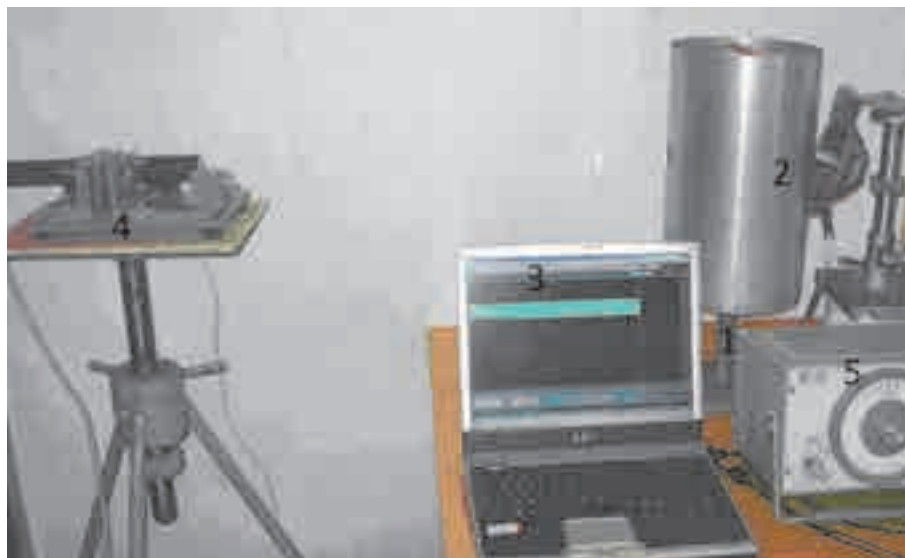
Рис. 3. Экспериментальная установка для бесконтактного определения дефектов виброакустическим методом в моделях оболочек с использованием лазерного голографического интерферометра:
