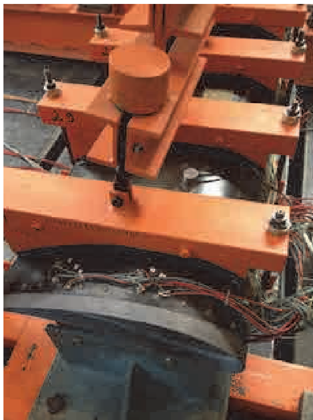
Рис. 2. Прочностные испытания дефлектора закрылка с применением метода АЭ на испытательном стенде
