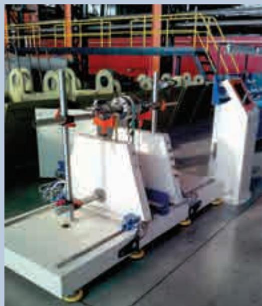
Для балансировки широкого перечня роторов различных масс разработана линейка универсальных балансировочных станков типа xB с горизонтальной осью вращения.
