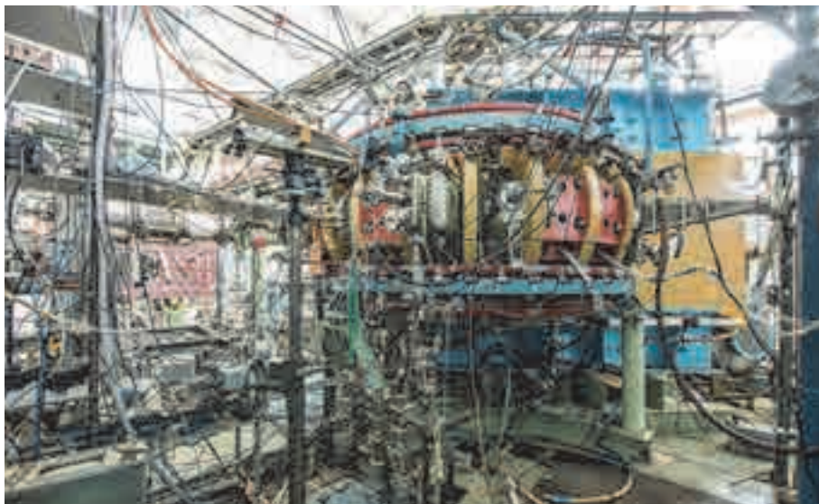
Установка магнитного термоядерного синтеза – токамак Т-11М
