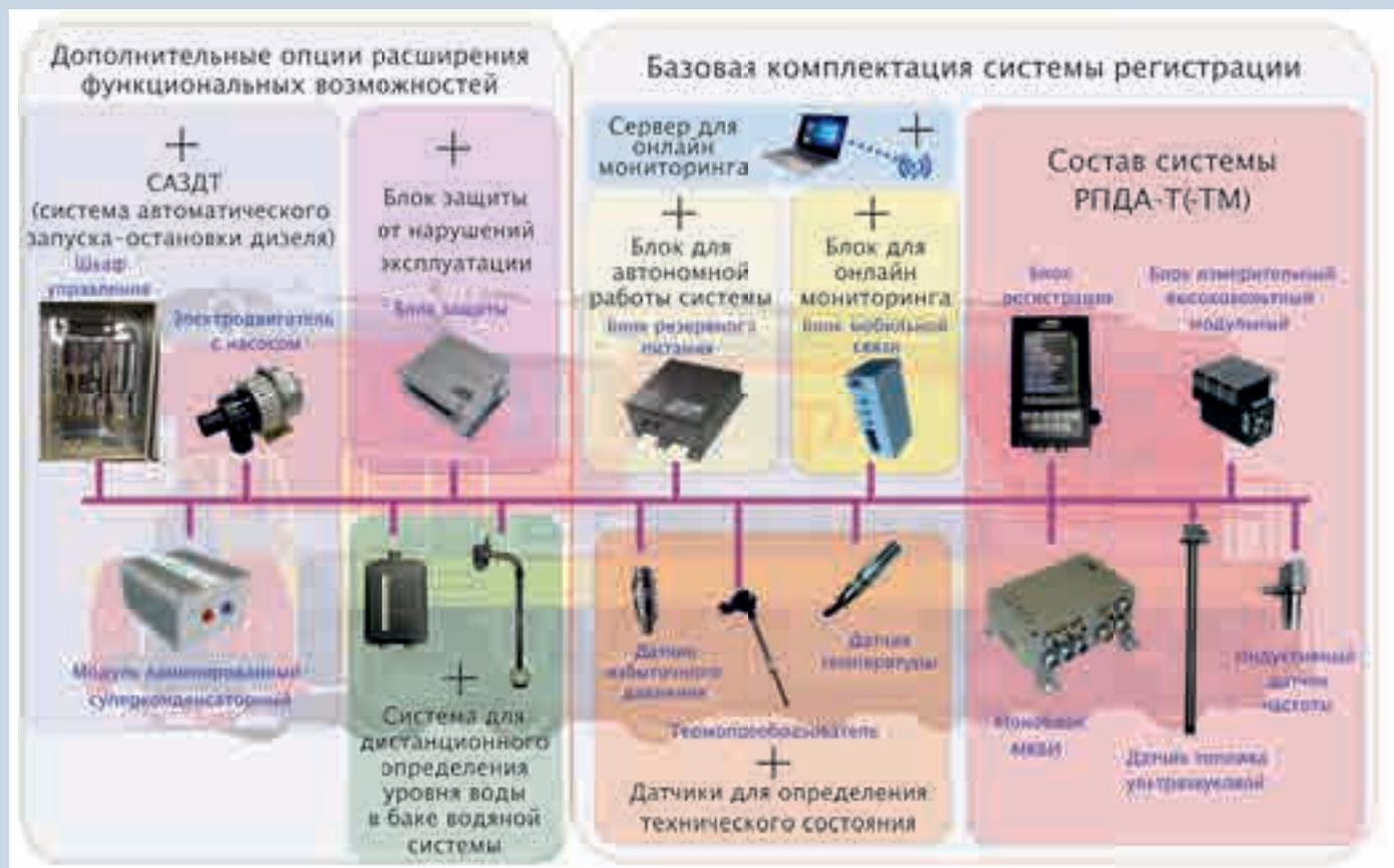
Комплексная автоматизированная система регистрации движения, параметров работы, контроля наличия и расхода дизельного топлива РПДА-Т(-ТМ) с дополнительными функциями самопрогрева и технической диагностики для тепловозов
