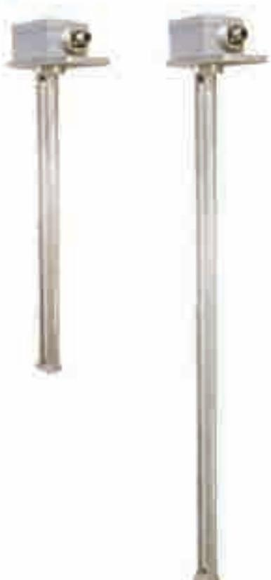
Ультразвуковой датчик контроля уровня, плотности и температуры топлива ДТУ с передачей информации по интерфейсу RS-485 совмещает 3 функции измерения в компактном взрывозащищенном корпусе с применением инновационных обеспечивающей безопасную работу устройства в сложных условиях эксплуатации. ДТУ отличается отсутствием движущихся частей, устойчивостью к вибрациям, а также высокой точностью благодаря ультразвуковому принципу измерения.
