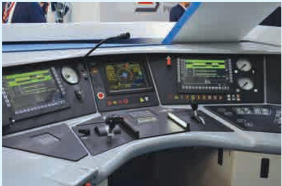
*Комплексная система управления и диагностики электропоезда четвертого поколения УПУ-4*
