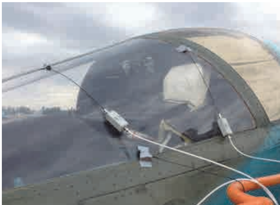
Рисунок 3. Вариант размещения датчиков акустической эмиссии на остеклении фонаря кабины воздушного судна
