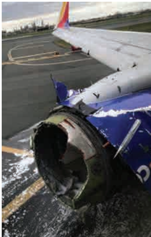
Рисунок 1. Последствия возникновения помпажа
