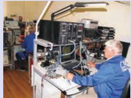
**Диагностика аппаратуры систем автоведения на специализированном стендовом оборудовании**
