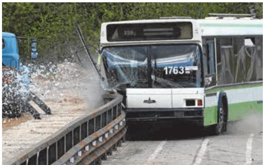
**Рисунок 2. Краш-тест жесткого препятствия при столкновении с автобусом**
