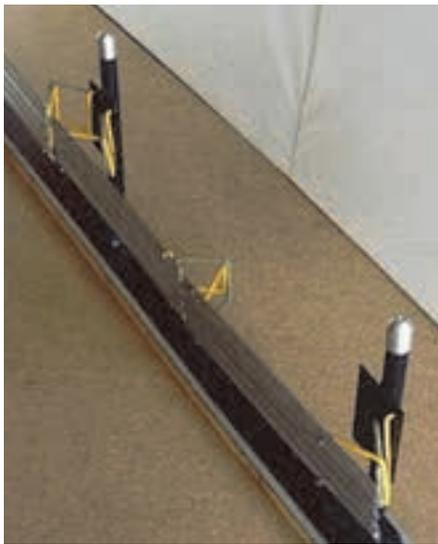
Рисунок 6. Макет энергопоглощающего ограждения
