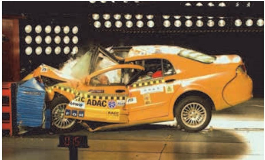
**Рисунок 1. Краш-тест автомобиля при столкновении с препятствием**
