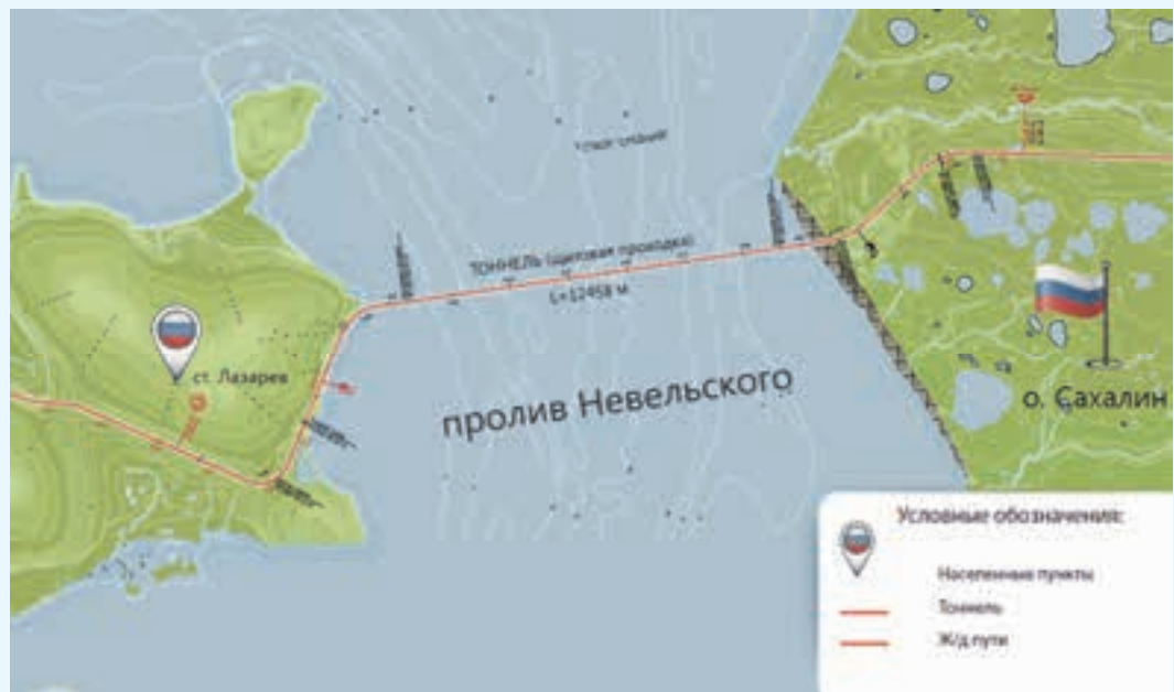
Рис. 6. Тоннельный вариант перехода через пролив Невельского
