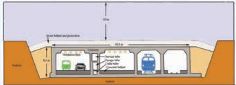
Рис. 5. Сечение тоннеля в эксплуатации
