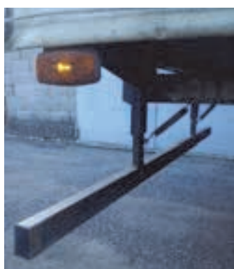
Рис. 7. Исходное состояние дорожного ограждения с установленным в нём торсионным энергопоглощающим элементом
