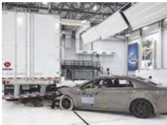
Рис. 9. Применение торсионных амортизаторов для защиты легковых машин от попадания под большегрузные грузовые автомобили
