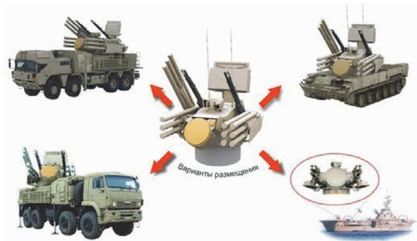
Рис. 5. Модификации ЗРПК «Панцирь-С1»
