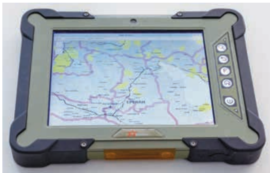
Рис. 1. Картографический пакет на защищенном планшете ОНИКС08
