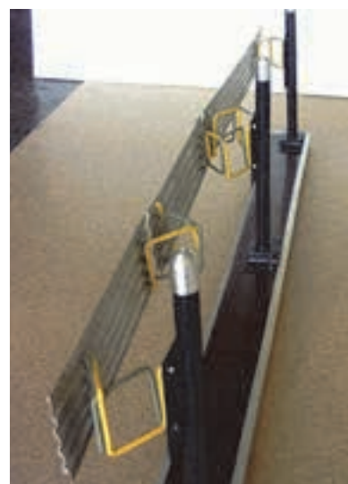
Рис. 8. Варианты установки торсионных энергопоглощающих элементов на дорожном ограждении
