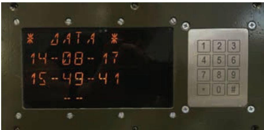
Блок индикации и управления заправкой (монтируется в отсеке специального технологического оборудования изделия ТС СГ)
