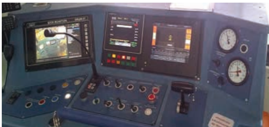
Рис. 3. Блок терминала машиниста аппаратуры ПАМ-АТП на составе 81-722
