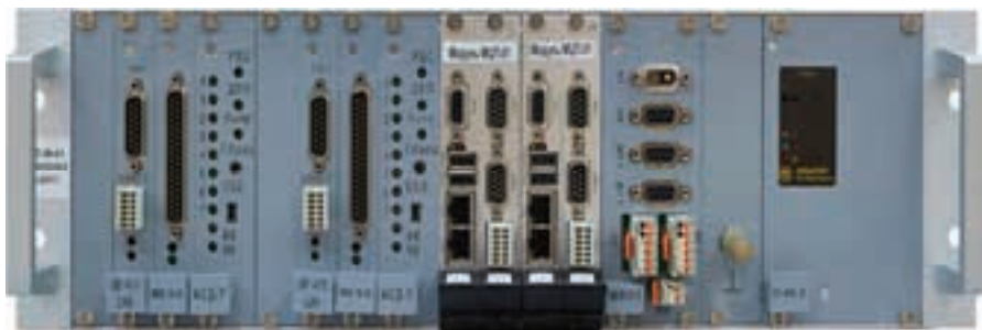
Рис. 2. Блок автоведения аппаратуры ПАМ-АТП на составе 81-722 и его модификациях
