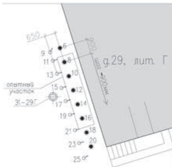
Рис. 11. Расположение опытного участка и экстензометрической скважины Э1–29Г
