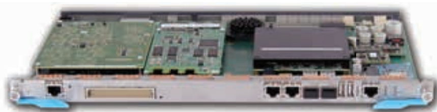
Плата компактного программного коммутатора (SI3000 CCS). Производится в г. Екатеринбург
