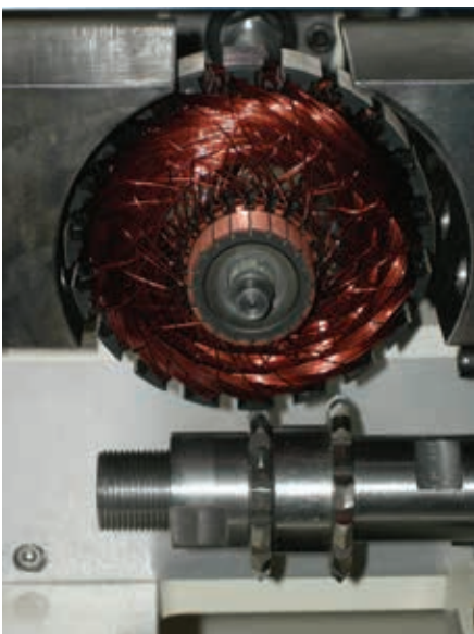
Фрезерование ротора при балансировке
