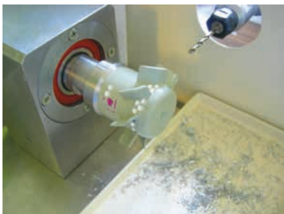
Вентилятор, шпиндель сверлильной позиции и поворотная цанга станка
