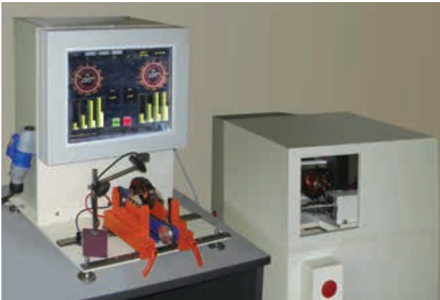
Станок ATM-001AB для балансировки роторов методом фрезерования
