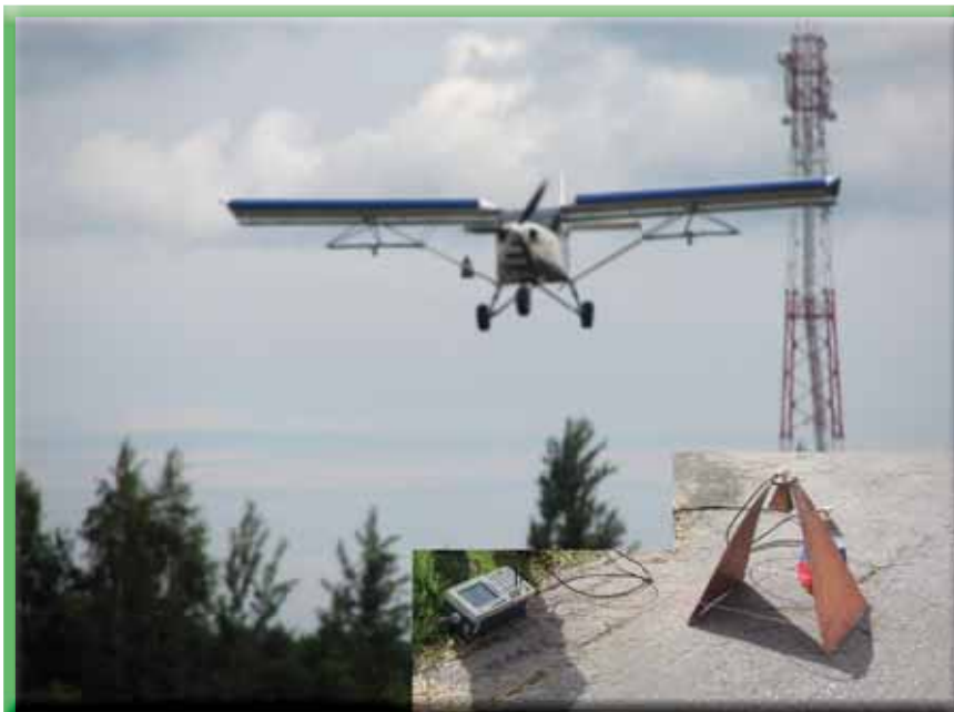
Рис. 3. Высота полета 20 м; 50 м; 90м. Скорость 90 км/ч. Справа внизу – приемник и антенна м-диапазона на ВПП
